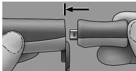
Durante el proceso de carga parpadea de color verde el indicador de estado de la pieza de mano. Una vez finalizado el proceso de carga, el indicador de estado muestra una luz constante de color verde. **Durante la carga no es posible ninguna exposición, por motivos de seguridad.**
