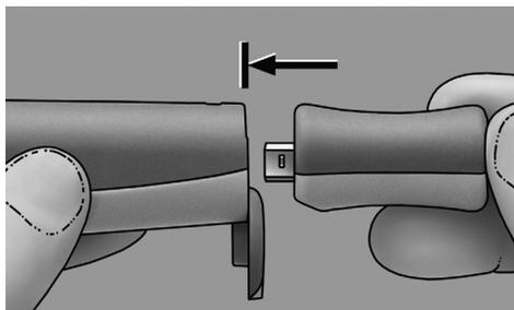
L'indicateur de charge de la pièce à main clignote en vert durant le processus de chargement. Après la fin du processus de chargement, l'indicateur de charge brille en vert de manière continue. **Pour des raisons de sécurité, une exposition n'est pas possible durant le chargement.**
