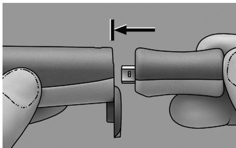
Durante o processo de carregamento, o indicador de estado da peça de mão pisca com a cor verde. Após concluído o processo de carregamento, o indicador de estado permanece continuamente aceso com a cor verde. **Por motivos de segurança, não é permitida qualquer emissão de luz durante a fase de carregamento.**
